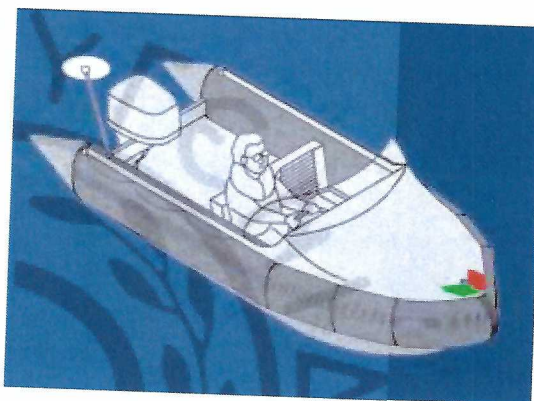
Σχ. 1.23ζ Φανοί ναυσιπλοΐας μικρού πλοίου με μήκος < 12 m, με ενσωματωμένους πλευρικούς φανούς σε ένα σύνθετο δίχρωμο.
